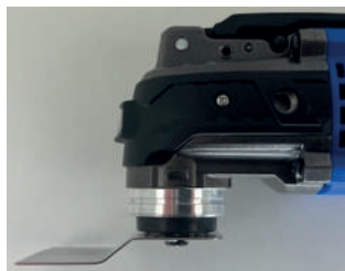
Lamă de ferăstrău instalată corect.
