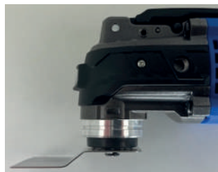
Helyesen telepített fűrészlap.
