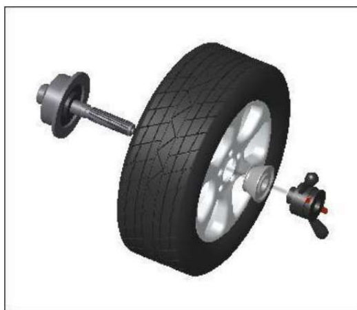
1 Montaż typu: koło-stożek-nakrętka (zalecane do felg stalowych)
