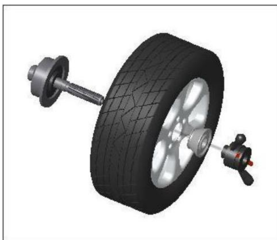
1 Montaż typu: koło-stożek-nakrętka (zalecane do felg stalowych)
