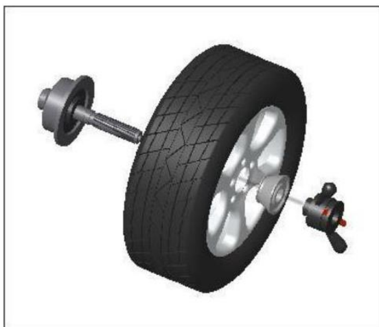
1 Montaż typu: koło-stożek-nakrętka (zalecane do felg stalowych)
