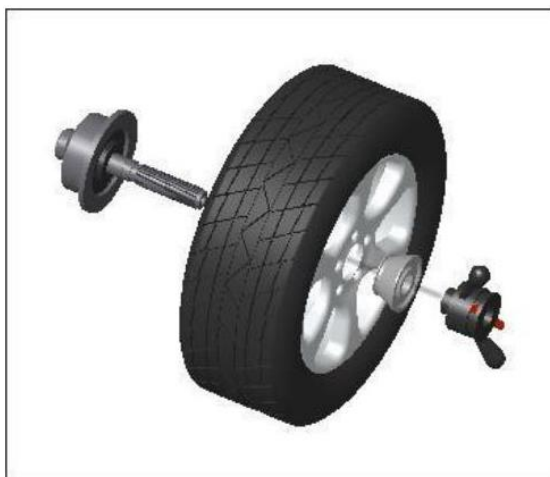
1 Montaż typu: koło-stożek-nakrętka (zalecane do felg stalowych)
